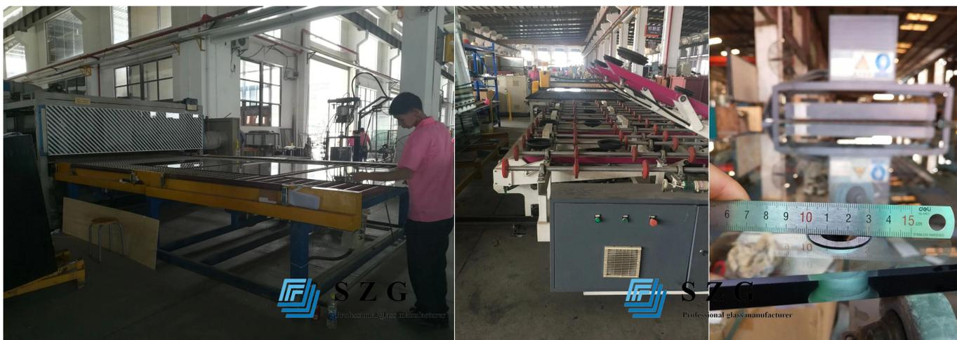
4. Inspección muy estricta dos veces después de la entrega de vidrio, inspeccione la tolerancia de los orificios de vidrio, la dimensión, garantiza que cada pieza de vidrio se pueda entregar a la mano del cliente será perfecta.
