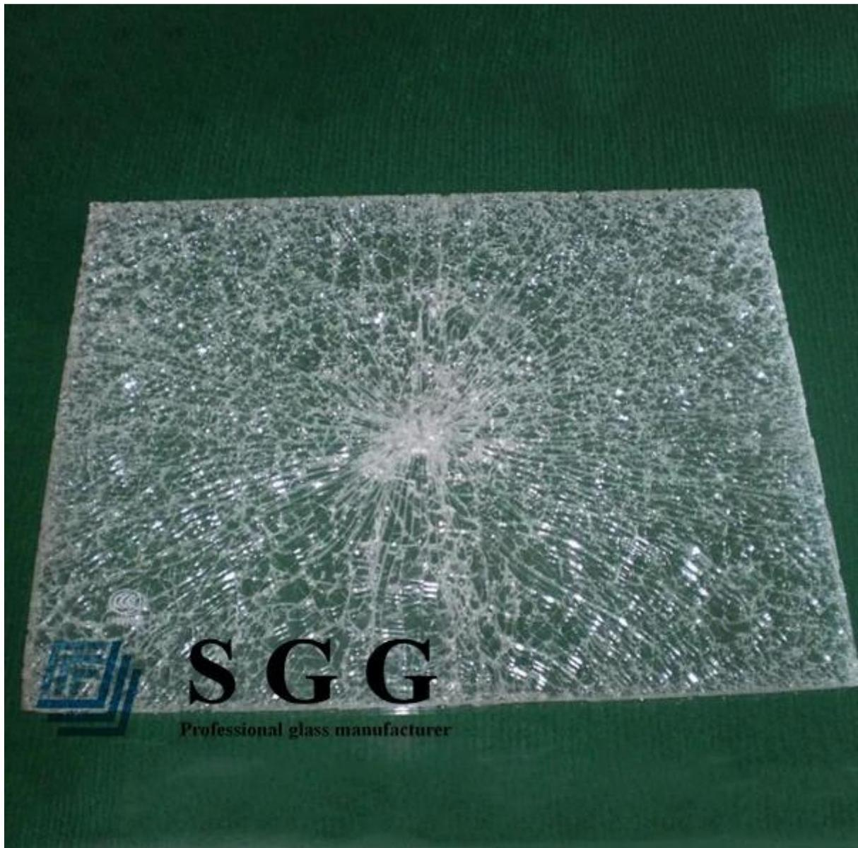
**Rottura del vetro stratificato temperato:**
