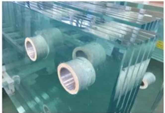
Neste caso 15.15.15.15.4 Vidro laminado ultra claro temperado embebido em calor, adotando o filme SGP, que pode reforçar a qualidade e o desempenho do vidro. Por causa de [teste embebido em calor](#) pode fazer o vidro temperado ter um desempenho mais estável, para reduzir a incidência do vidro moderado temperado do baixo ferro que quebra espontaneamente após a instalação.
